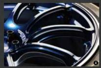
デモカーのBRZにイチ早くRZⅡを導入した Kansai サービス。「剛性を維持しながらストイッ クに軽量化を追求しているにも関わらず、リム外 周部にはダイヤモンドカットでアクセントを与 える①など、ハイセンスに仕上げられていますよ ね」と、その魅力を語るのは代表の向井さん。均 等な10本スポークに対し、RZ II はツインスポー クに近い不均等の10本スポークを採用。広角側 のスポークサイド②は、センターサークル付近も 含めて継ぎ目なく"アドバンスド・サイドカット" を施し、軽量化に貢献。対面の狭角側③でも、ス ポーク上部にリブを設けて強度を確保したうえで、 スポーク下部では大胆な駄肉カットを行っている。 また、「抑揚感のあるフェイス④もカッコよさを 助長する重要なポイントになっていると思う」と、 向井さん。大きくラウンドしたスポークとセンタ ーパートの深さが立体感を創出し、抑揚感を生み 出しているのだ
